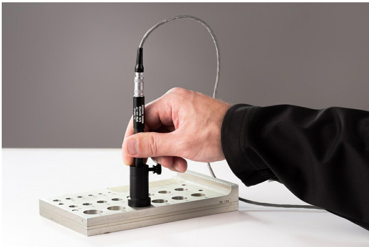
Obrázek 4. Standardní ruční sonda a kabel s viditelným typickým zkrucením kabelu, ke kterému dochází při ručním zkoušení otvorů pro spojovací prvky a šrouby.
